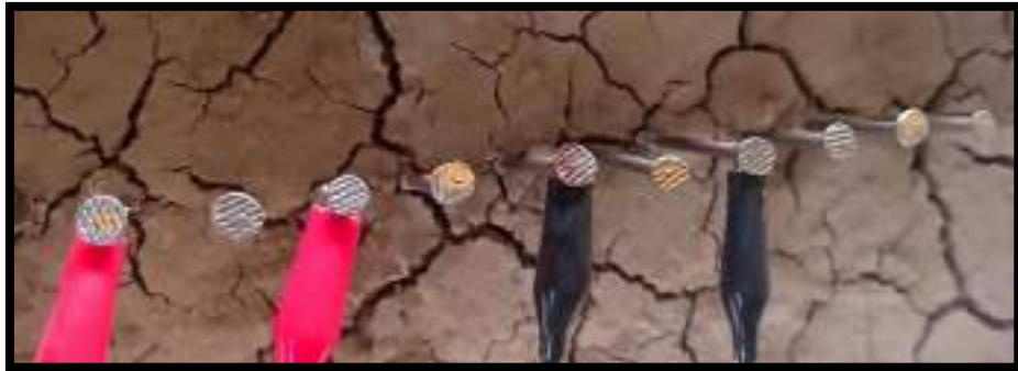
Gambar 4.3 Foto Penempatan Elektroda Spasi Sama (Konfigurasi Wenner Alpha)
